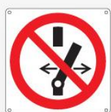
Vietato alterare lo stato dell'interruttore P031
