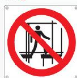
Vietato l'uso di questa impalcatura incompleta P025
